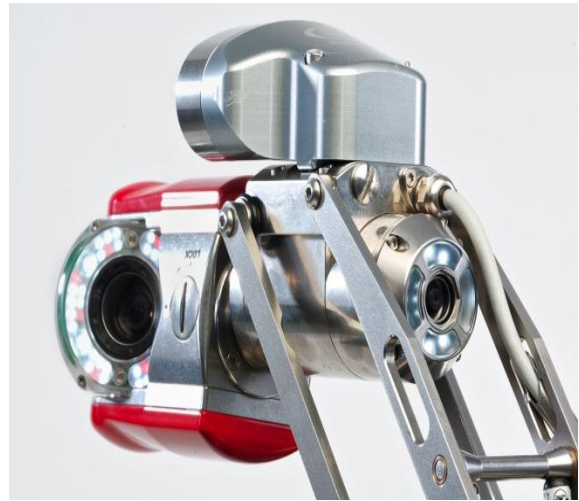
Abbildung 2: Die Kameraskwenkköpfe werden zum Teil von maxon RE-Motoren bewegt. © 2012 iPEK
